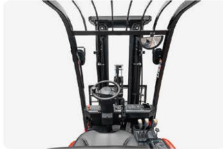
Nuevo diseño del mástil que permite una mayor visibilidad delantera
