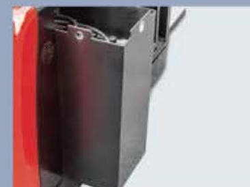
Desalojo lateral de la batería
