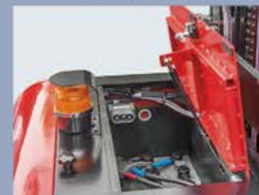
La cubierta trasera se puede quitar fácilmente para facilitar el trabajo de mantenimiento en piezas tales como la unidad hidráulica, el sistema de control electrónico y el motor.
