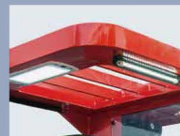
La lámpara de LED superior puede proporcionar un entorno operativo iluminado
