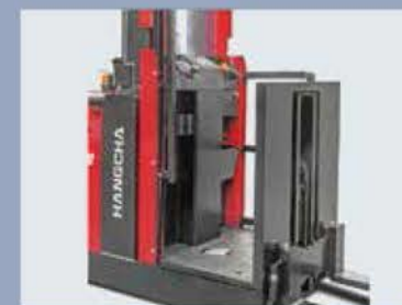
El preparador de pedidos solo funciona cuando las barreras laterales están bajadas
