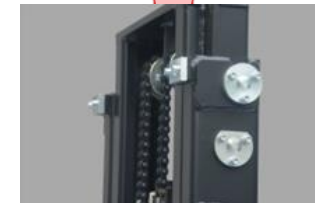
Las barras de refuerzo se colocan entre el mástil interior y exterior
