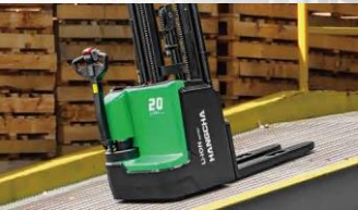
Función de paro en pendiente, aumenta la seguridad de uso.
